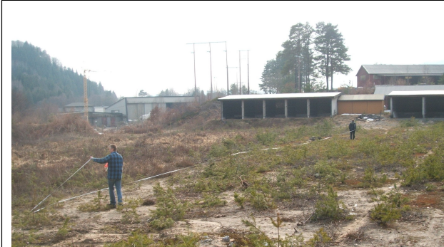
Avstanden ble målt mange ganger, både med laser og målband
