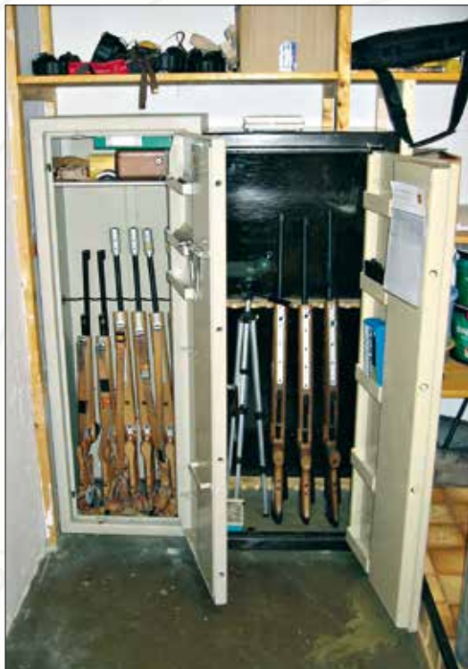
Våpenskap skal boltes fast iht. monteringsanvisningen.
